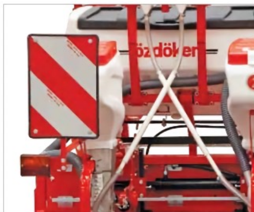
SÚPRAVA PRE DOPRAVU - OSVETLENIE
